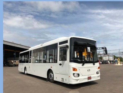
日野ディーゼル電気 ハイブリッド(HV)バス 1モータ平行式 ハイブリッド(HV)システム
