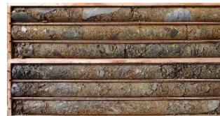
ハイブリッド工法による 地すべり地層のコア写真
