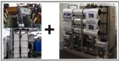
「小型 RO 膜ろ過装置」に浸漬 UF 膜ろ過装置を連結 ⇒「濁り」と「塩分」を除去
